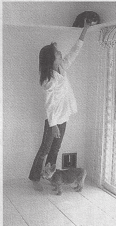
五井さん宅のリビング。床は滑りにくいタイル敷き、天井には猫が歩く「キャットウォーク」、壁下には犬猫の出入り口をつけた。東京都多摩市
